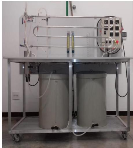
Figura 1 – Trocador de calor bitubular objeto deste estudo.
