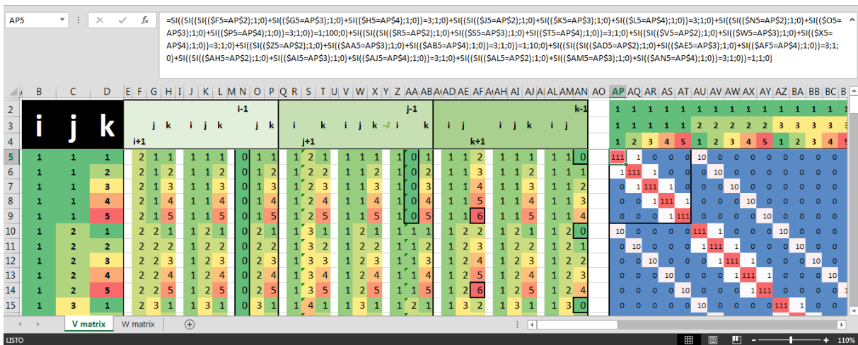
Figura 6 – Implementação do algoritmo de determinação da matriz de estabilidade V
