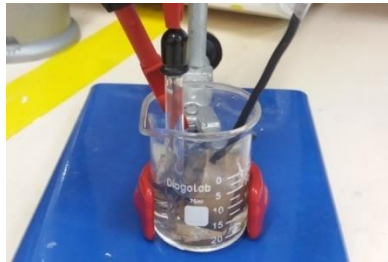
Figura 2: Disposição dos três eletrodos durante os ensaios (fonte: Autor, 2017).
