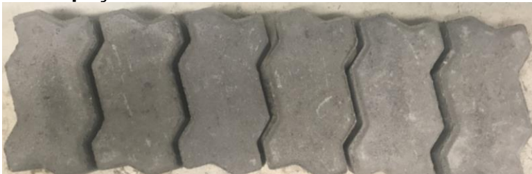
Figura 1 – Bloco de concreto sem CCA
