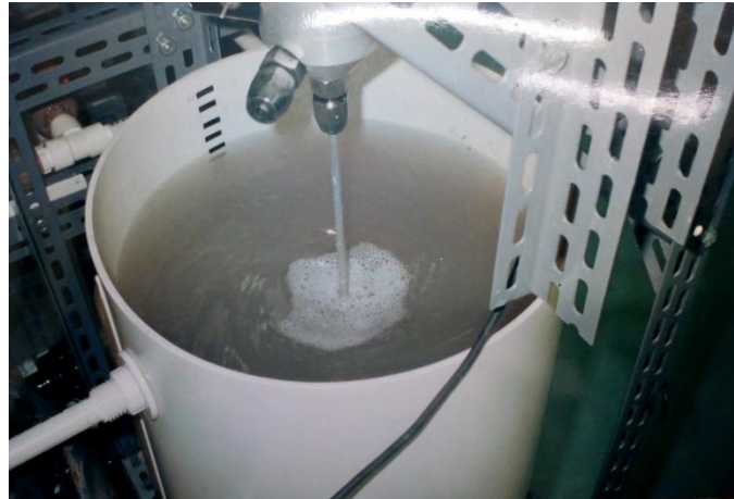
Figura1: Vaso misturador utilizado na simulação.O dispositivo possui raio de 19 cm e altura de 35,2 cm. Foi simulado a utilização de 80% do volume total do tanque, equivalente a 40 L.
