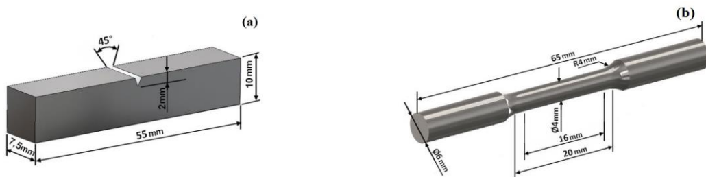
Figura 1- Desenho esquemático dos corpos de prova (a) tenacidade ao impacto Charpy e (b) tração uniaxial.
