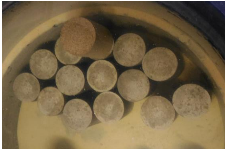
Figura 2 - Corpos de prova cilíndricos moldados para caracterização da resistência à compressão média do concreto utilizado.
