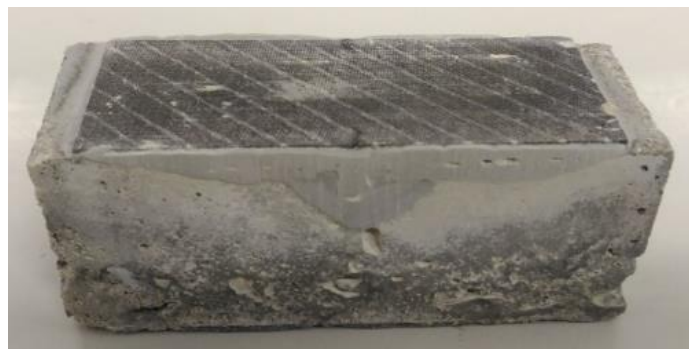
Figura 6 – Corpo de prova de concreto reforçado com material compósito de fibra de carbono
