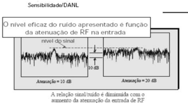
FIGURA 155 – O NÍVEL EFICAZ DO RUÍDO APRESENTADO É FUNÇÃO DA ATENUAÇÃO DE RF
