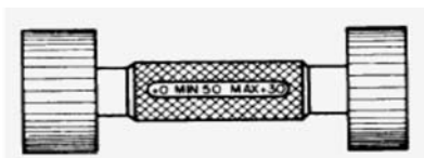
FIGURA 23 – CALIBRADOR-TAMPÃO “PASSA NÃO-PASSA” FONTE: CATÁLOGO GEDORE, 2008/9
