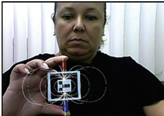
Figura 6 - Campo magnético de um ímã em forma de barra
