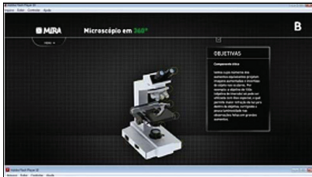
Figura 3 - Microscópio virtual – identificação das objetivas e suas funções
