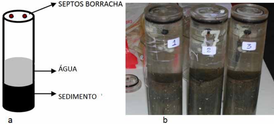
Figura 8 - Esquema (a) e Foto (b) dos tubos de acrílico (testemunhos) usados para determinação dos fluxos de metano na interface sedimento-água
