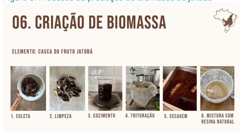
Figura 5. Processo de produção da biomassa de jatobá
