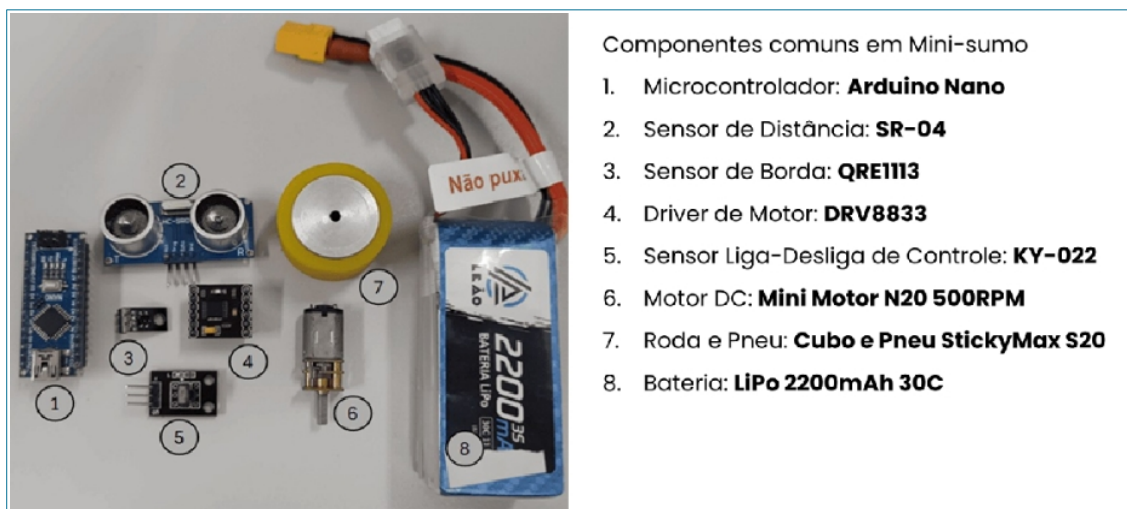
Figura 3. Componentes comuns utilizados na montagem de um robô mini-sumô
