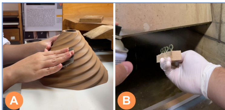
Figura 7. Acabamento superficial das peças: [A] lixamento da cúpula e [B] aplicação de primer nas peças complementares
