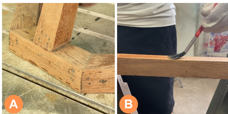
Figura 3. Processamento das madeiras: [A] união com cola branca e pinos de aço e [B] envernizamento das partes
